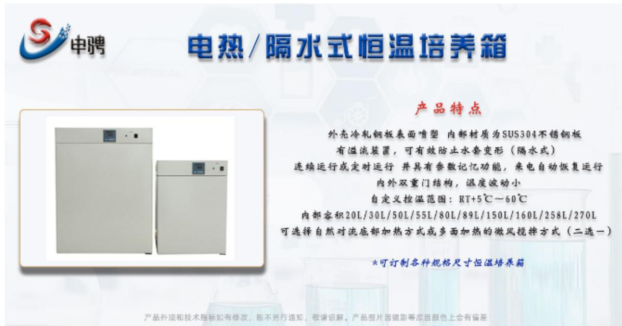
产品特点有哪些呢大屏幕液晶显示，多组数据一屏显示，菜单式操作界面，简单易懂，便于操作。双层门结构，隔热性能好，观察箱内情况时不影响箱内温度。采用镜面不锈钢内胆，四角半圆弧设计易清洁，箱内搁板间距可调。箱体外壳采用冷轧钢板制造，表面静电喷塑电热膜加热方式，加热速度快。\*\*限温报警系统，超过限制温度即自动中断，保证实验安全运行不发生意外。（选配）具有RS485接口可连接记录仪和计算机，能记录温度参数的变化状况。（选配）震荡培养箱定做上海申骋仪器可供应培养箱 欢迎来电咨询。
